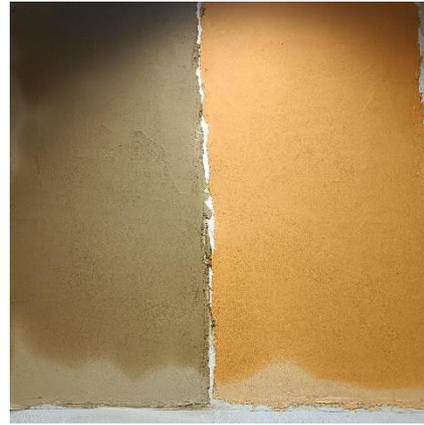
**Application mouillée, l'enduit teinté est foncé, éclaircissement au séchage
