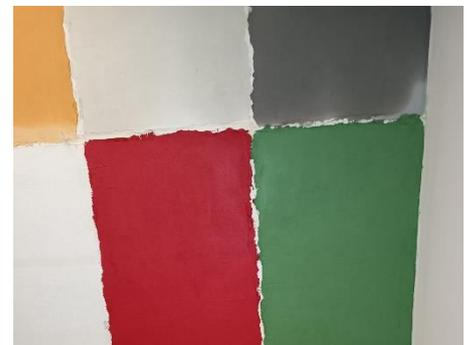
**Mettre la teinte dans l'eau (adapter l'eau en fonction du volume d'enduit à appliquer et Malaxer 5 minutes avec une Turbine pour bien mélanger (laisser poser 5 minutes) et appliquer directement sur le primaire d'accrochage sec**
