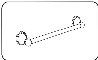
S'assurer que le dispositif est fixé au mur en déplaçant doucement les deux montants d'un côté à l'autre.
