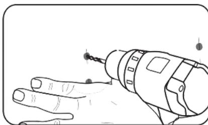
À l'aide d'une perceuse et d'un foret de 1/4 po (6,35 mm), percer deux trous verticaux.
