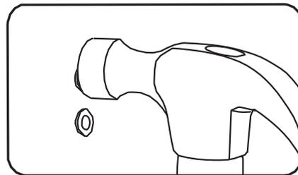
Insérer les ancrages en plastique dans les trous percés. Tapoter légèrement avec le marteau jusqu'à ce qu'ils soient au ras du mur.
