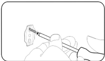
Positionner les supports de montage contre les trous d'ancrage et les vis filetées jusqu'à fixation.
