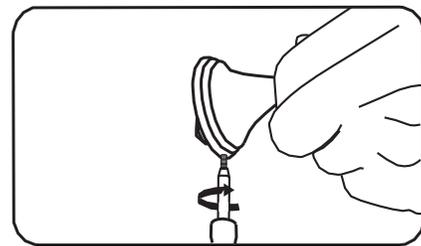
Placer le dispositif entièrement assemblé par-dessus le support de montage. À l'aide d'un tournevis, serrer le dispositif sur le support de montage.
