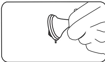
À l'aide d'un tournevis, desserrer la vis jusqu'à ce que le dispositif puisse reposer à ras du support de montage.
