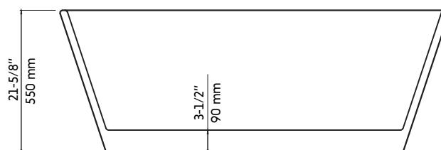
\* Ces dimensions de fixations sont en pouce ou en millimètres et peuvent varier de  $\pm 1/4"$  (6 mm). Le dessin n'est pas à l'échelle. Ces dimensions peuvent être changées à la discrétion du fabricant. Aucune responsabilité n'est assumée.
