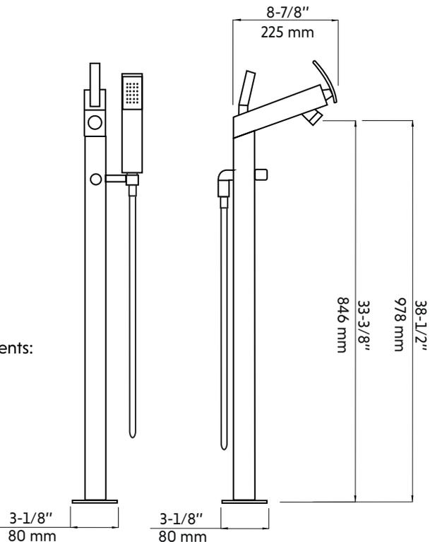
\* Ces dimensions de fixations sont en pouce ou en millimètres et peuvent varier de  $\pm 1/4"$  (6 mm). Le dessin n'est pas à l'échelle. Ces dimensions peuvent être changées à la discrétion du fabricant. Aucune responsabilité n'est assumée.
