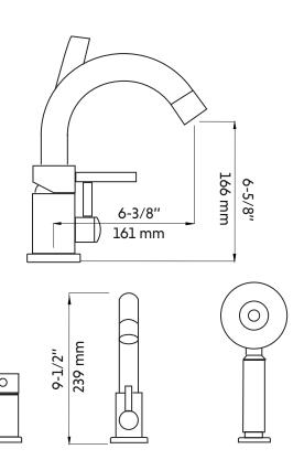
$<sup>^{*}</sup>$  Ces dimensions de fixations sont en pouce ou en millimètres et peuvent varier de  $\pm$  1/4" (6 mm). Le dessin n'est pas à l'échelle. Ces dimensions peuvent être changées à la discrétion du fabricant. Aucune responsabilité n'est assumée.
