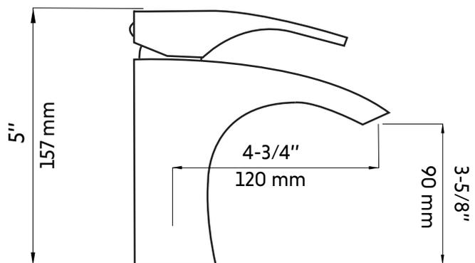
\* Ces dimensions de fixations sont en pouce ou en millimètres et peuvent varier de  $\pm 1/4"$  (6 mm). Le dessin n'est pas à l'échelle. Ces dimensions peuvent être changées à la discrétion du fabricant. Aucune responsabilité n'est assumée.
