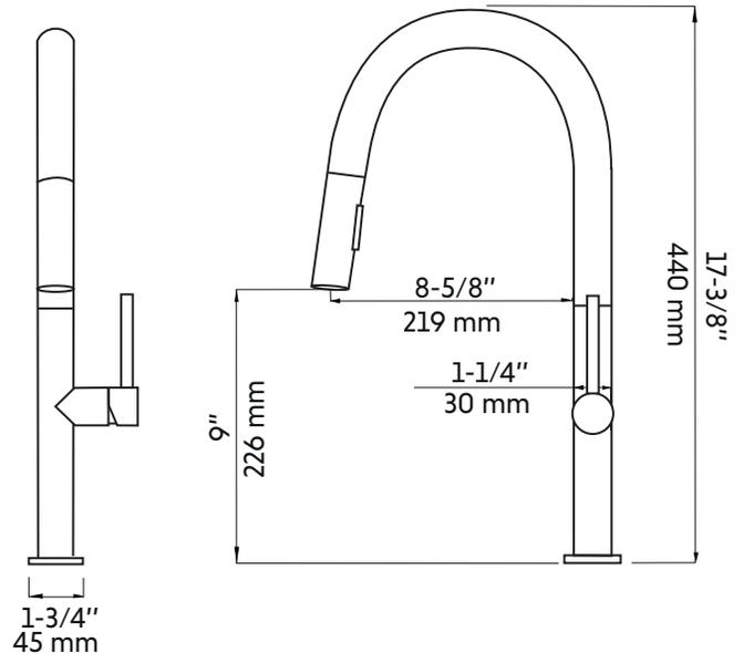
\* Ces dimensions de fixations sont en pouce ou en millimètres et peuvent varier de  $\pm 1/4"$  (6 mm). Le dessin n'est pas à l'échelle. Ces dimensions peuvent être changées à la discrétion du fabricant. Aucune responsabilité n'est assumée.
