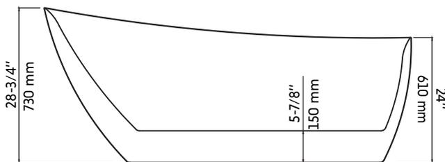
\* Ces dimensions de fixations sont en pouce ou en millimètres et peuvent varier de  $\pm 1/4$ " (6 mm). Le dessin n'est pas à l'échelle. Ces dimensions peuvent être changées à la discrétion du fabricant. Aucune responsabilité n'est assumée.
