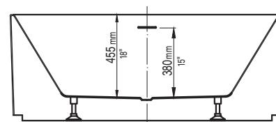
\* Ces dimensions de fixations sont en pouce ou en millimètres et peuvent varier de  $\pm 1/4"$  (6 mm). Le dessin n'est pas à l'échelle. Ces dimensions peuvent être changées à la discréion du fabricant. Aucune responsabilité n'est assumée.
