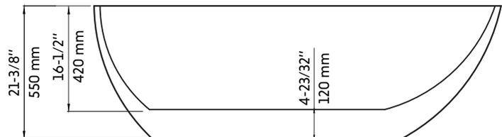
\* Ces dimensions de fixations sont en pouce ou en millimètres et peuvent varier de  $\pm 1/4"$  (6 mm). Le dessin n'est pas à l'échelle. Ces dimensions peuvent être changées à la discrétion du fabricant. Aucune responsabilité n'est assumée.
