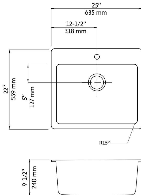
\* Ces dimensions de fixations sont en pouce ou en millimètres et peuvent varier de  $\pm 1/4"$  (6 mm). Le dessin n'est pas à l'échelle. Ces dimensions peuvent être changées à la discrétion du fabricant. Aucune responsabilité n'est assumée.
