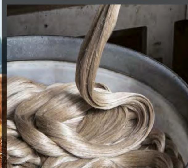
Im September wird der Flachs zu großen Ballen gewickelt und weiterverarbeitet: Zunächst werden die langen Pflanzenfasern von der holzigen Schale getrennt. Beim anschließenden Spinnen werden die einzelnen Fasern durch Verdrehen zu einem Garn zusammengefügt. Ausgewählte Garne werden dann auf Webstühlen zu feinen Leinenstoffen verarbeitet.
