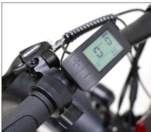
Le dispositif de contrôle et la manette d'accélérateur sont situés sur la poignée gauche du guidon
