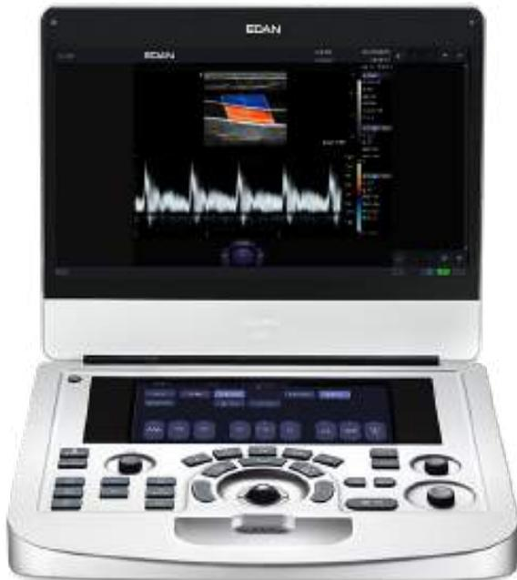
Monitor grado medico LCD de 15.6” con alta resolución y plegable hasta 180°
