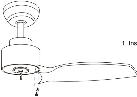
1. Installation der Klappen Total 3 Klappen, 6 Schrauben.
