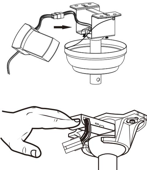
3. Sobald der Verdrahtungsschritt abgeschlossen ist, schieben Sie den kabelgebundenen Fernbedienungsempfänger zwischen die Montagehalterung und die Oberseite der Downrod-Kugel für Downrod-Lüfter.
