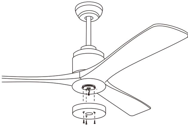
2. Installieren Sie das Licht Kit, Gesamt 3 Schrauben.
