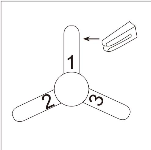
Setzen Sie den Clip in die Mitte einer Klinge. Schalten Sie den Ventilator ein und wenn das Zittern anhält, stecken Sie den Clip in eine andere Klinge, bis das Wackeln reduziert ist. Dann braucht diese Klinge das Gegengewicht.
