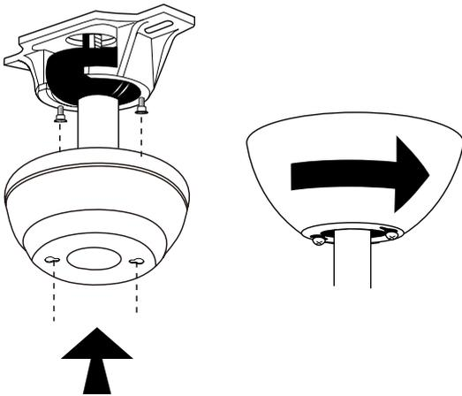
1. Schieben Sie den Baldachin vorsichtig auf die Unterseite der Montagehalterung, machen Sie zwei Gleitlöcher, die auf die beiden vorstehenden ausgerichtet sind Schrauben an der Montagehalterung und drehen Sie sie dann im Uhrzeigersinn, bis sie fest sind.
