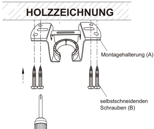
Verwenden Sie für Holzdecken eine Holzschraube, um auf dem Holzbalken zu bohren, oder die Anschlussdose, um die Hängehalterung zu befestigen (die Auswahl erfolgt nach den tatsächlichen Anforderungen des Kunden).
