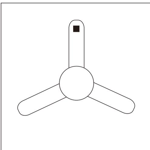
Kleben Sie das Gegengewicht auf die Oberfläche des Flügels in der Nähe des Clips, entfernen Sie den Clip und testen Sie den Lüfter. Wenn es weiter taumelt, setzen Sie ein weiteres Gegengewicht ein. Wenn es schlimmer wird, versuchen Sie es an einem anderen besseren Ort. Bitte versuchen Sie es geduldig, bis der Lüfter im Gleichgewicht ist.
