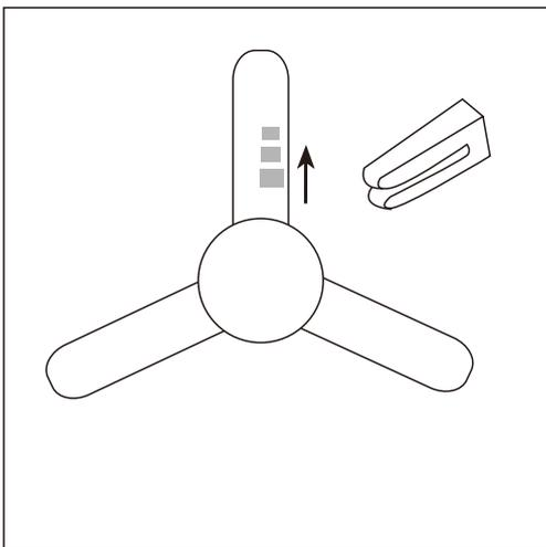
Setzen Sie den Clip auf die Klinge, die das Gegengewicht benötigt, und versuchen Sie, die beste Stelle, um sie zu platzieren, von der Mitte bis zur Spitze der Klinge, bis das Wackeln verschwindet.
