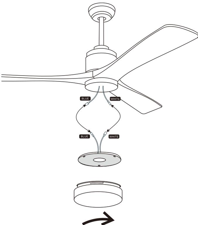
3. Schließen Sie die Drähte des Lüfters und des Lichtkits an.
