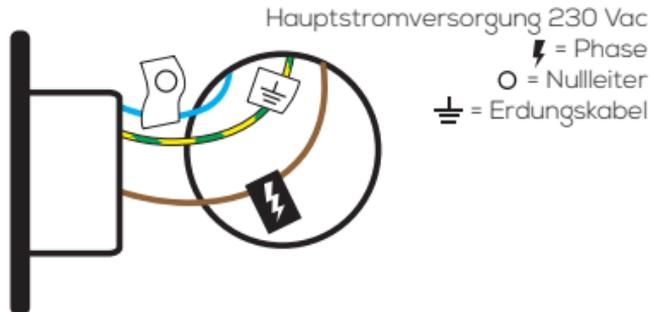
Entfernen Sie die alte Steckdose und kennzeichnen Sie die Drähte. Denken Sie daran, dass Sie den Nullleiter benötigen, um Steckdose zu installieren.
