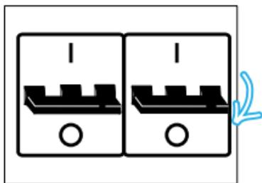
Apaga el contactor del enchufe que estás sustituyendo.
