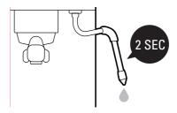
Immergez la buse de sorte que l'extrémité de la buse vapeur soit proche de la paroi du pichet (imaginez que vous séparez la section supérieure en quatre parties et placez-le au centre de l'une d'elles) et à environ un centimètre au-dessous de la surface du lait. Puisque le lait prend du volume, vous devrez abaisser progressivement le pichet afin de conserver l'extrémité de la buse toujours à la même profondeur. Cette phase se termine lorsque
