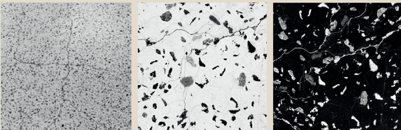
*La aparición de grietas o fisuras, como se muestra en las imágenes, es un comportamiento normal de este tipo de material, especialmente cuando está expuesto a cambios de temperatura*
