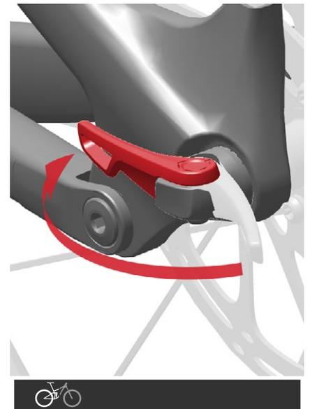
Feche a alavanca e confirme que ela não toca no garfo nem no quadro. A tensão na alavanca será suficiente se a alavanca deixar uma marca impressa na sua mão.
