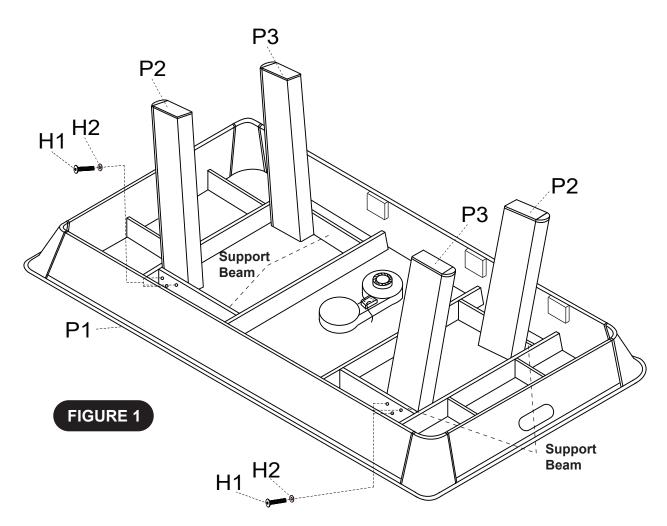
NOTE:BE SURE LEFT LEGS(P2) AND RIGHT LEGS(P3) ARE INSTALLED INSIDE OF SUPPORT BEAMS AS PER DIAGRAM
