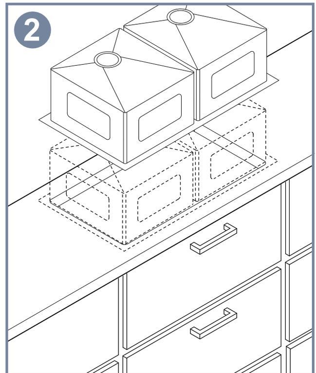
Paso2: Una vez realizado el orificio, voltear el tope y alinear el fregadero con la abertura.
