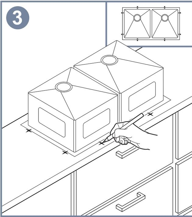
Paso 3: Marcar la distribución de los soportes de montaje, el espacio de manera uniforme alrededor de la parte inferior.
