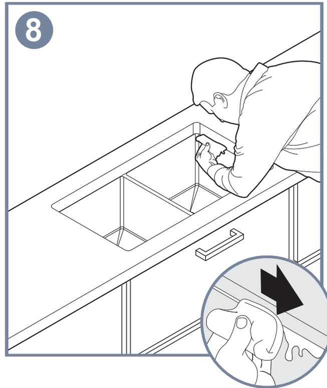
Paso 8: Terminar la instalación del tope y limpiar cualquier exceso.
