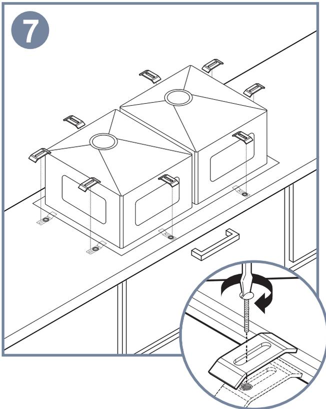
Paso 7: Colocación y sujeción de los accesorios de montaje.
