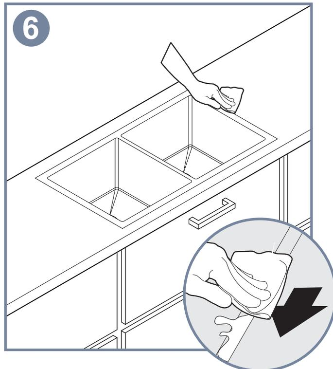
Paso 6: Limpie cualquier exceso de material. Posteriormente inicie con la instalación de grifo, desagües y accesorios.
