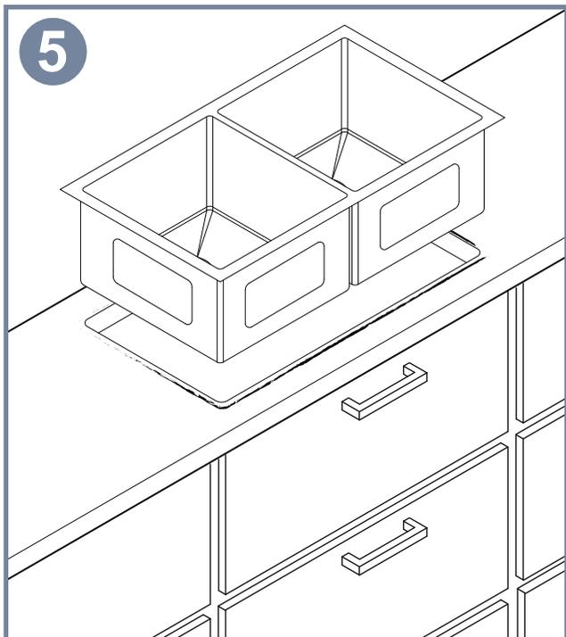
Paso 5: Coloque el fregadero en la posición correspondiente.
