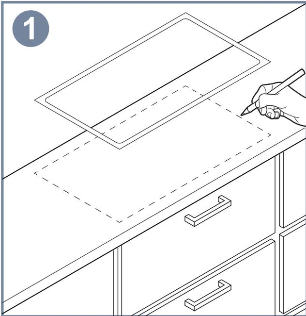
Paso1: Usando la plantilla de corte, el instalador puede marcar la trayectoria de corte para abrir el orificio en la superficie del tope.
