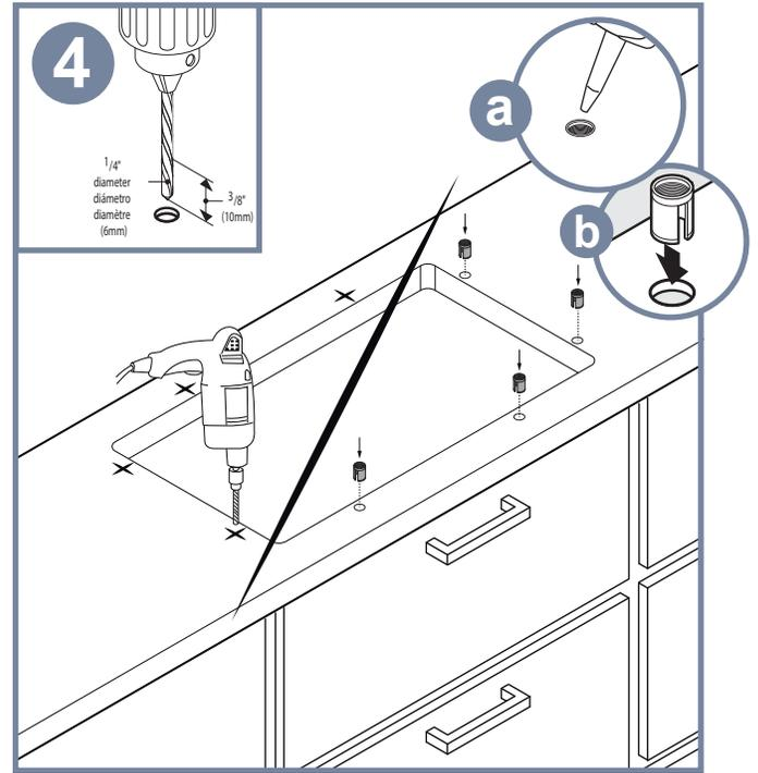
Paso 4: Luego de marcar retirar el fregador y taladrar los agujeros con una profundidad de 10 mm. Luego (a) rellenar los agujeros con pega epóxica (no incluida), (b) introducir los anclajes plásticos.
