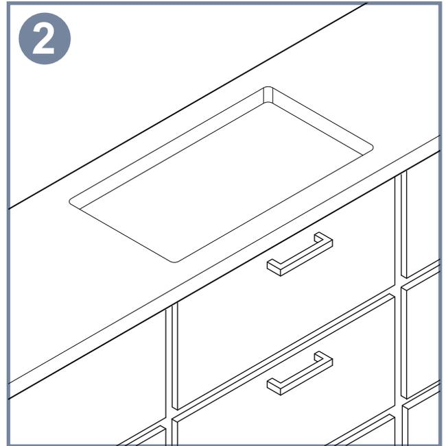
Paso2: Una vez realizado el orificio, voltear el tope y alinear el fregadero con la abertura.
