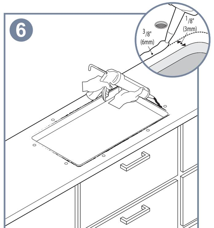
Paso 6: Proceda con el aplique de la silicona, recubriendo los bordes del recorte del tope. Luego coloque el fregador en la posición correspondiente. (silicona no incluida, consulte a su instalador profesional que silicona puede usar).
