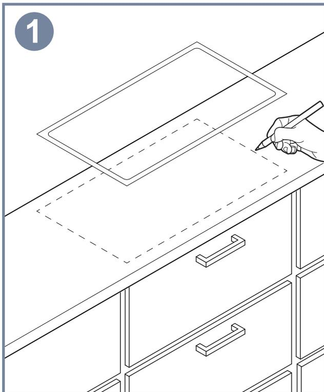
Paso1: Usando la plantilla de corte, el instalador puede marcar la trayectoria de corte para abrir el orificio en la superficie del tope.
