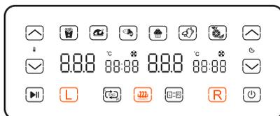
3. Utilisez les flèches TEMP pour régler la température (Le temps s'achève automatiquement en fonction de la température cible).
