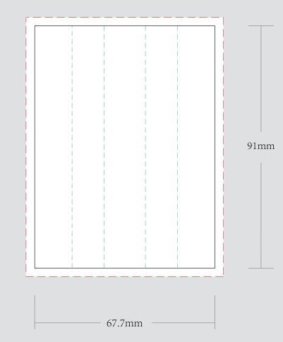
210g单铜纸 注:内托所有的虚线做针孔线 内托一定要贴在内盒里
