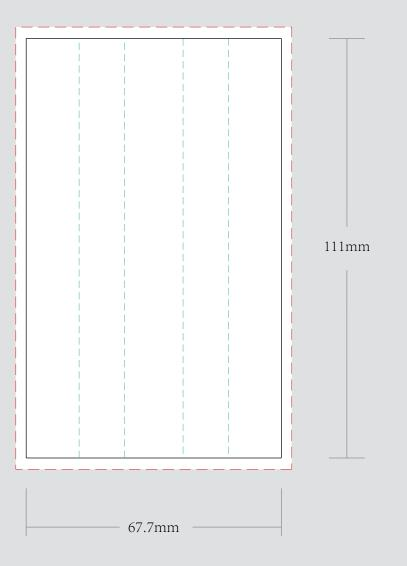
210g单铜纸 注:内托所有的虚线做针孔线 内托一定要贴在内盒里
