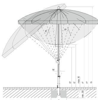
Revêtement de chaussée non fixé max. 10 cm, épaisseur du béton min. 30 cm (tenir compte de la profondeur hors gel), garantir l'écoulement de l'eau
