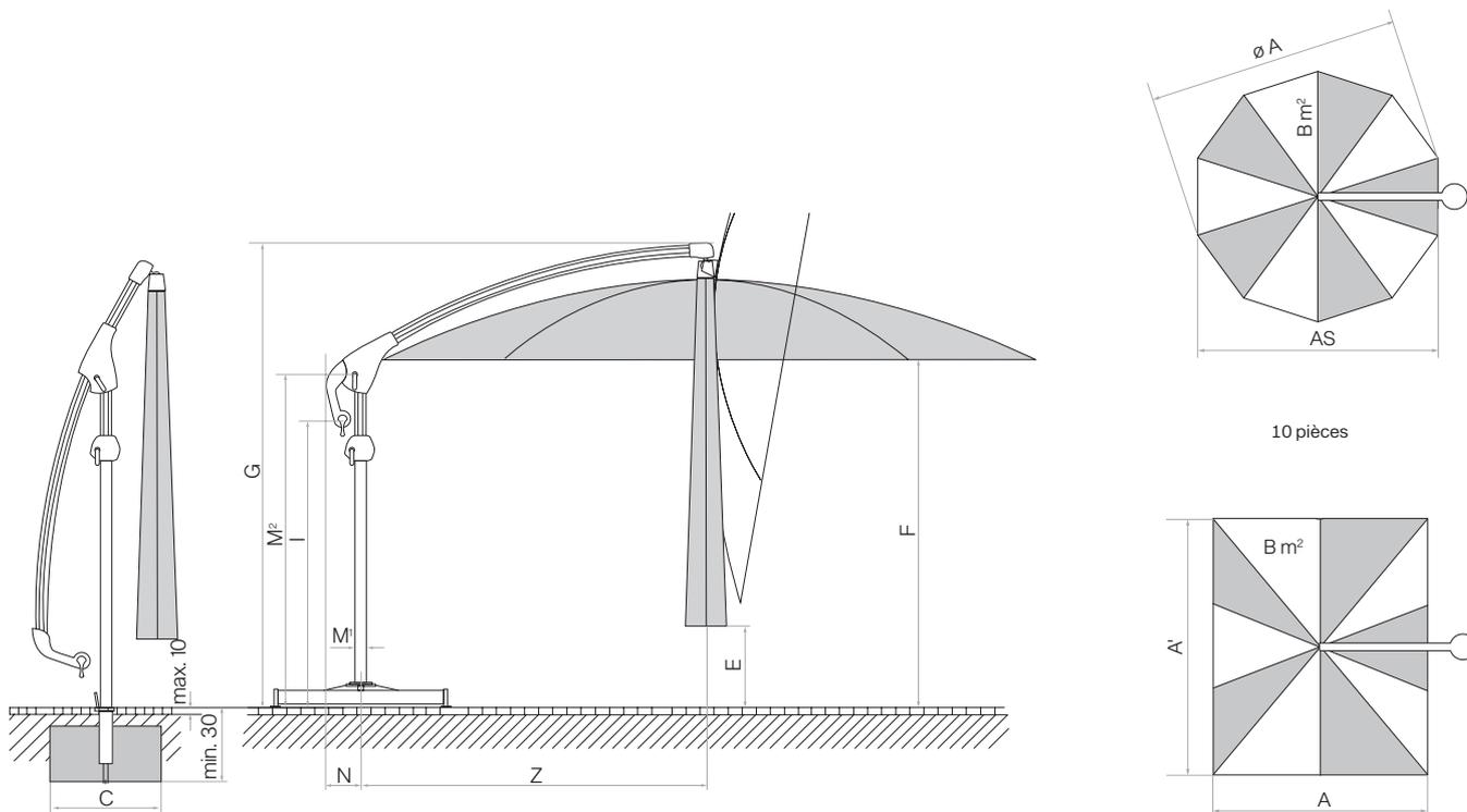
Revêtement de chaussée non fixé max. 10 cm, épaisseur du béton min. 30 cm (tenir compte de la profondeur hors gel), écoulement de l'eau
