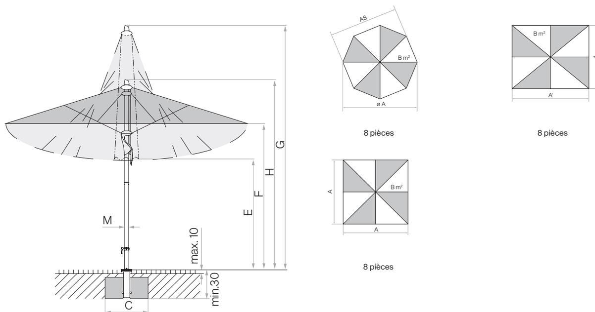
Revêtement de chaussée non fixé max. 10 cm, épaisseur du béton min. 30 cm (tenir compte de la profondeur hors gel), écoulement de l'eau
