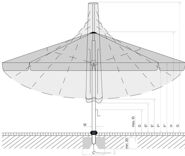
Revêtement de chaussée non fixé max. 10 cm, épaisseur du béton min. 30 cm (tenir compte de la profondeur hors gel), garantissant l'écoulement de l'eau, ligne d'alimentation électrique.
