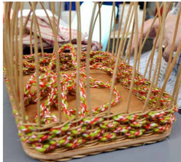
Bakke flettes af peddigrør og hjemmeslået reb på træbund på kursus for folkeskolelærere på Den danske Design- og Håndværksskole i Skjern.
