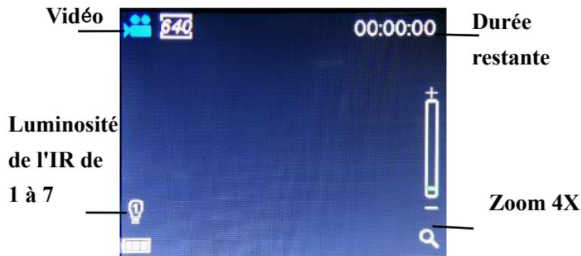
**Remarque** : si vous êtes trop près ou trop loin de l'objectif, la qualité des photos ou des vidéos ne sera pas optimale. Faites pivoter l'objectif vers la gauche ou la droite pour mettre au point sur l'objet d'observation.
