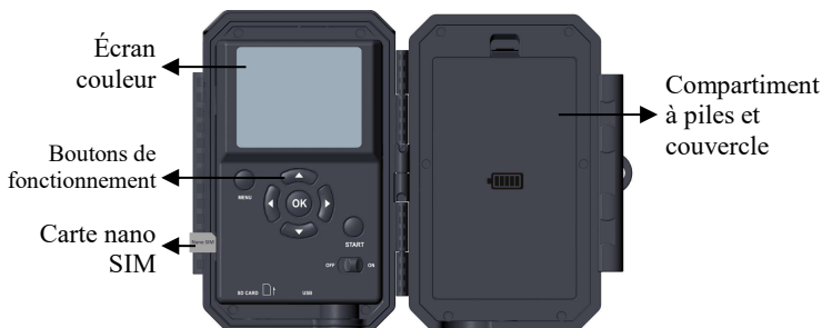
Figure 4 : Vue intérieure et carte SIM préinstallée
