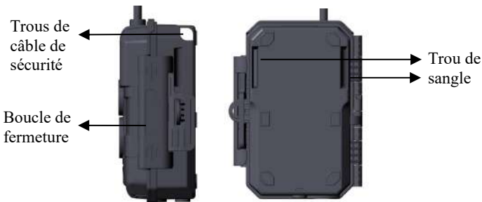
Figure 3: Vue de derrière
