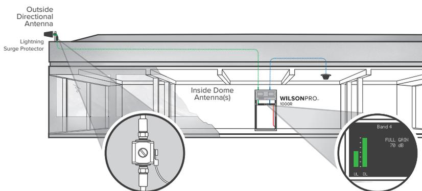
L'orientation de l'antenne extérieure doit être réglée jusqu'à ce que la barre DL (liaison descendante) soit maximisée.
