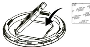
\* Il est recommandé de remplacer le dessiccateur une fois par mois. Ne le laissez pas tomber dans la trémie, et ne l'utilisez JAMAIS s'il est endommagé.
