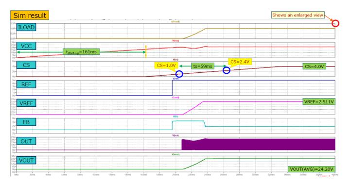
PWM control(Input=141V Output=24V IOUT=1.0A  $f_{SW}$ =77kHz)
