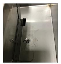
**HEARTH BURNER** SLOT MUST ENGAGE **POST**
