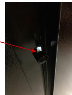
24. Per estendere il portautensili retrattile far scorrere il portautensili verso l'alto fino a quando le viti a testa in plastica possono essere sterzate nei "ganci" sul lato sinistro della scanalatura del portautensili.
