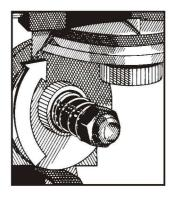
E. Regolare la vite di blocco (13) per controllare il pezzo da limare.
