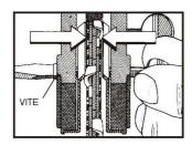
E. Assicurare le barre a "T" (5) utilizzando la vite ad alette (6) e quella con testa a intaglio dalla parte opposta, in modo da centrare la catena e stabilizzare la lima per l'affilatura.
