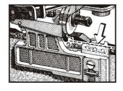
C. Montare la lima sula barra di guida in modo che le barre a "T" della catena di guida (5) siano allineate con la parte superiore dei rivetti della catena. Serrare il gruppo con la vite di blocco (8).
