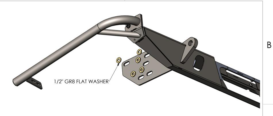
AFTER THE BEDSIDEDS HAVE BEEN TRIMMED. MOUNT THE BUMPER TO THE PICKUP USING THE SUPPLIED 1/2" GRADE 8 FLAT WASHERS AND FACTORY M12 BOLTS. ADJUST BUMPER IN SLOTS TO GET DESIRED FITMENT. TORQUE TO 65 FT-LBS ON BOTH DRIVER AND PASSENGER SIDE.
