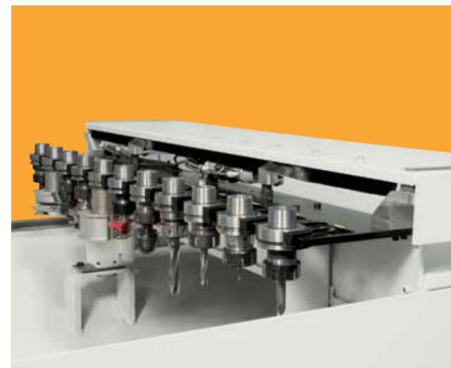
LINEAR T: magazzino a basamento per utensili di grandi dimensioni con copertura escludibile per la massima protezione degli utensili (opzionale).
