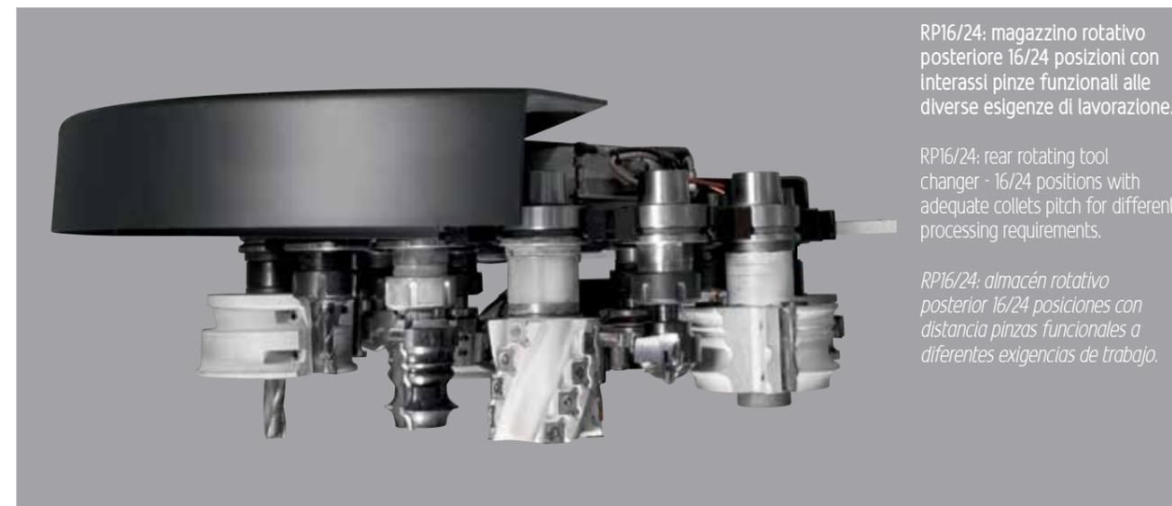
RP16/24: magazzino rotativo posteriore 16/24 posizioni con interassi pinze funzionali alle diverse esigenze di lavorazione.
