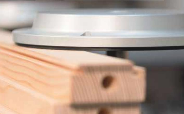
“Jet Fast” posizionamento automatico da CN. Veloce posizionamento di piani, ventose e bloccaggi. Nessun intervento da parte dell’operatore, massima precisione e grande flessibilità.
