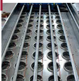
Pulizia unità filtrante con aria compressa. Filtering unit cleaning by compressed air. Nettoyage des filtres par air comprimé.
