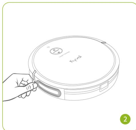
Bringen Sie die **Seitenbürste** in den **seitlichen Bürstenhalterungen** an der Unterseite des Saugroboters an.
