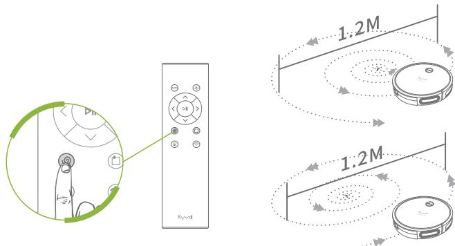
\* Нажмите кнопку на пылесосе Cybovac или кнопку на пульте ДУ, чтобы приостановить текущий режим работы; нажмите кнопку снова для перехода в автоматический режим. Если необходимо возобновить точечный режим, нажмите кнопку на пылесосе Cybovac или кнопку на пульте ДУ, чтобы приостановить процесс уборки, затем нажмите кнопку еще раз.
