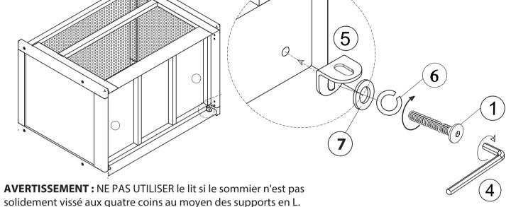
Tourner le lit sur le côté et dévisser les supports en L du sommier à l'aide de la clé Allen (M6). Mettre le sommier de côté pour l'instant. Retirer les supports en L du niveau inférieur en dévissant les 4 derniers boulons.
