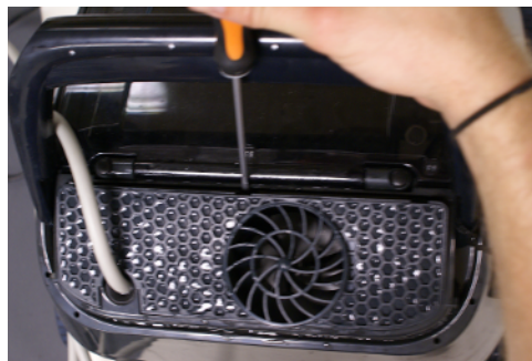
7.1. Za pomocą płaskiego śrubokrętu zdejmij kratkę ochronną.
