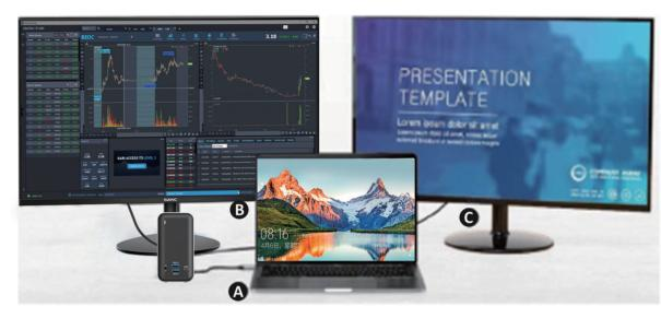
HDMI1 + HDMI2 OR HDMI1 + VGA OR HDMI2 + VGA
