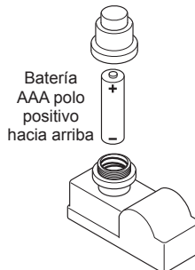
Figura 27 - Instalación de la batería en Ignitor
