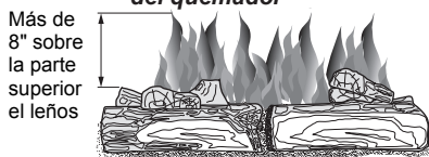
Figura 33 - Patrón incorrecto de la llama del quemador
