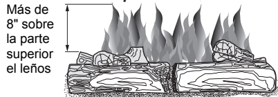
Figura 38 - Patrón incorrecto de la flama del quemador
