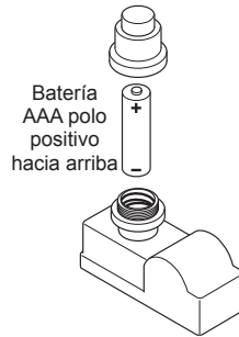
Figura 5 - Instalación de la batería en Ignitor
