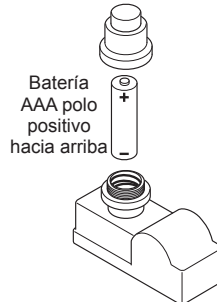
Figura 6 - Instalación de la batería en Ignitor
